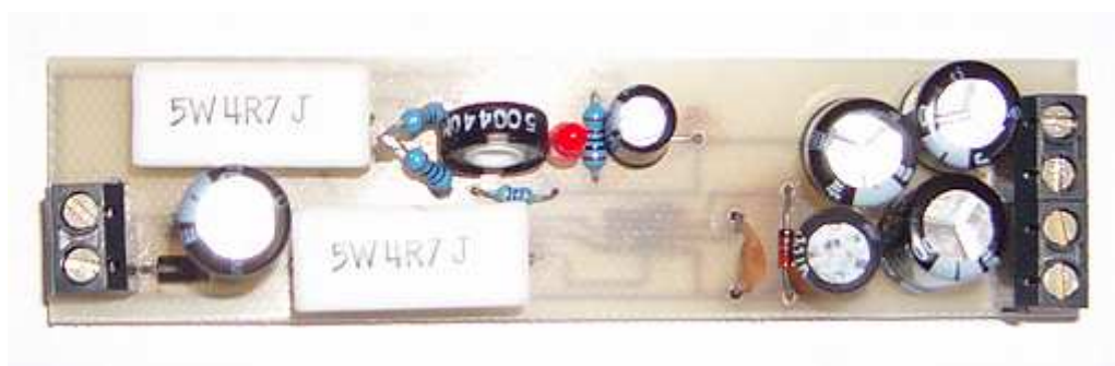
Konstrukce záložního zdroje 3,6V s MC34063 DC/DC měničem
